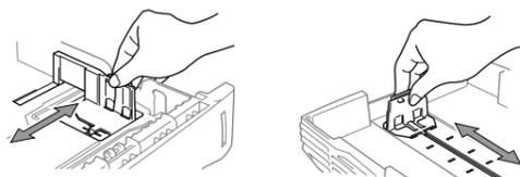
**C.** Chargez le papier dans la cassette. Appuyez sur la pile pour l'aplatir aux quatre coins en veillant à ce que la hauteur de la pile ne dépasse pas le repère.
