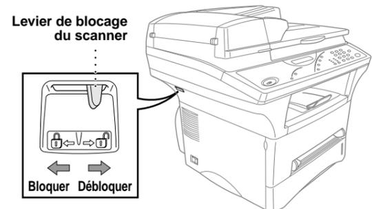
❗ Si le message VERIF.SCAN VEROU s'affiche à l'écran, vérifiez que le levier est bien en position de déverrouillage et appuyez sur **Arrêt**.
