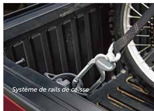
Caisse en matériau composite moulé renforcé de fibres
