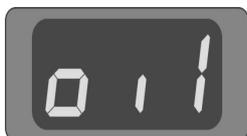
Après un intervalle de temps programmé, le panneau de commande active le signal { OIL }, qui signifie que l'intervalle vient d'expirer et que l'entretien peut être effectué. Le signal disparaît après 3 secondes et la machine peut être utilisée. Le signal continuera cependant à apparaître à chaque mise en marche de la machine.
