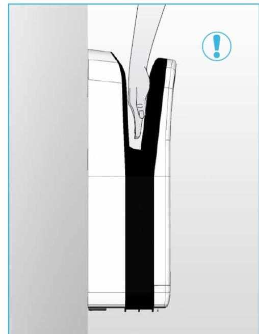
Wenn Sie die Hände vom Trockner entfernen, unterbricht dieser den Trocknungsvorgang und wartet auf den nächsten Benutzer. Wenn die Hände länger als 25 Sekunden im Trockner verbleiben, schaltet sich dieser automatisch ab.
