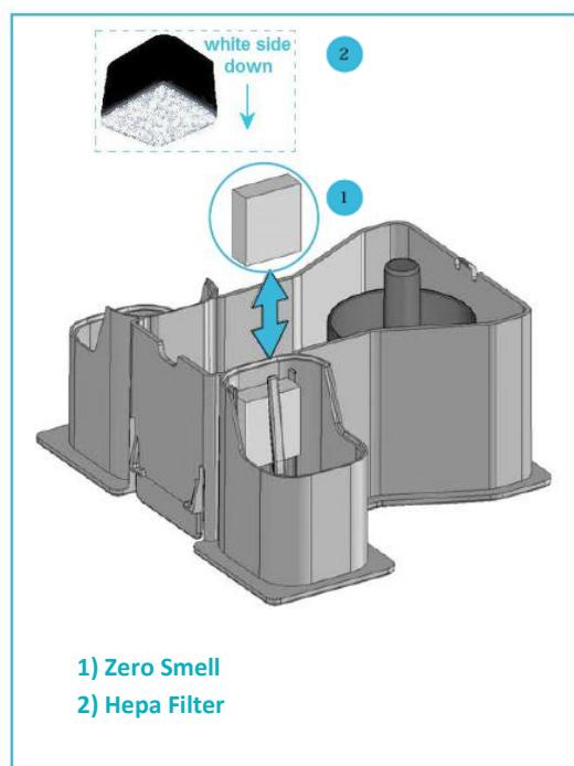
Die Luftfilter sollten einmal pro Woche überprüft werden. Entfernen Sie den Wasserspeicher und waschen Sie die Filter mit Wasser ab. So tauschen Sie auch den Zero Smell sowie den Hepa Filter aus.
