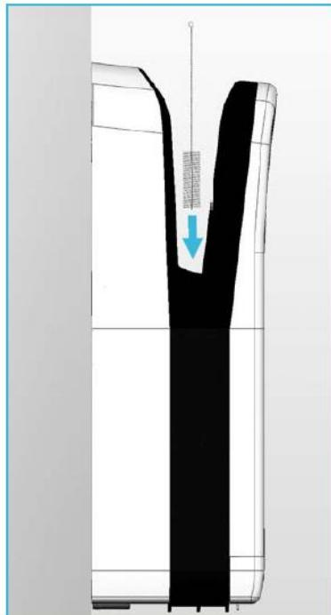
Dieses Produkt wird mit einer Bürste geliefert, welche für die Reinigung des Entwässerungskanals zu benutzen ist.
