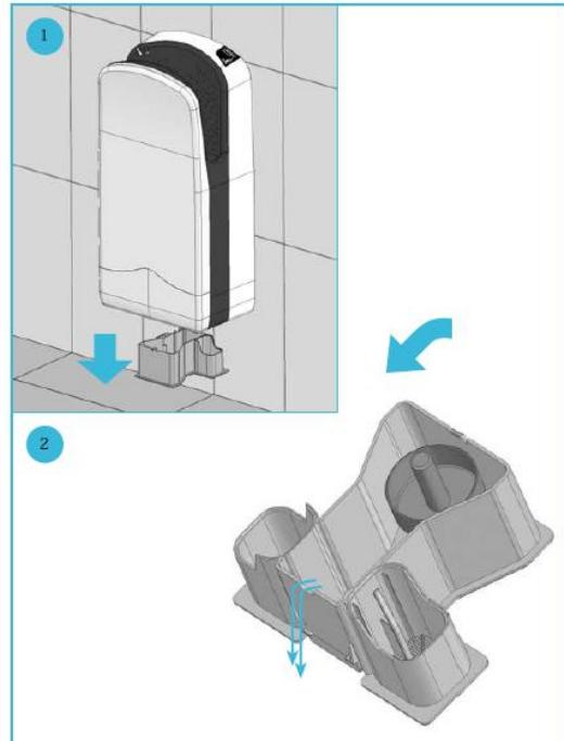
Wenn das Wasser das maximale Niveau im Speicher erreicht hat, erzeugt das Gerät einen optischen Alarm an der Geräteoberseite (rotes Licht) sowie ein akustisches Warnsignal. Der Wasserspeicher des Geräts muss entnommen, entleert und danach wieder eingesetzt werden. **Der Wasserspeicher muss mindesten einmal pro Woche überprüft und geleert werden.**
