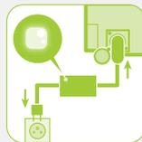
Connecter le chargeur à la batterie, et insérer la fiche du chargeur dans une prise de courant.
