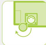
Ouvrir le cache pour découvrir la prise pour brancher le chargeur à la batterie.
