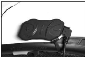
L'adaptateur micro-USB 2-broches peut être utilisé pour recharger le SMH10R avec la batterie. Vous devez d'abord connecter le câble USB d'alimentation et de données avec l'adaptateur micro-USB 2-broches puis le brancher sur la batterie SC-A0301 en séries. La batterie est vendue séparément comme accessoire optionnel.
