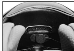
7. Fixez les bandes velcro pour la batterie (comme vous l'avez fait pour l'unité principale) et placez la batterie à l'arrière de votre casque. Fixez le connecteur de la batterie au connecteur à 2 broches du câble de l'unité principale.
