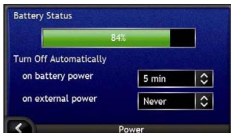
La barre **Battery Status** (État de la pile) montre le pourcentage d'énergie qui reste dans la pile de l'iCN ; le mot **Charging** (En charge) s'affichera lorsque la pile sera en cours de charge grâce à une source d'alimentation externe. Pour charger la pile, voir "Pile interne" à la page 16.
