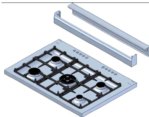
Désassembler la protection arrière et positionner la partie frontale sur le plan de travail. Aligner les orifices des vis avec les orifices correspondants à l'arrière du plan de travail.
