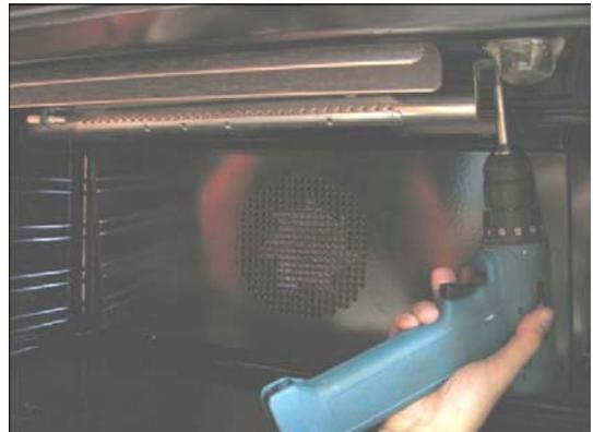
En utilisant un [nom de l'outil] de 7 mm., dévisser l'injecteur. Remplacer l'injecteur en utilisant l'équipement de conversion fourni avec la cuisinière ou par un magasin Bertazzoni agréé de pièces de rechange. Chaque injecteur comporte un numéro indiquant son diamètre de flux imprimé sur le corps. Consulter le tableau à la page 20 la correspondance entre les injecteurs et les brûleurs.
