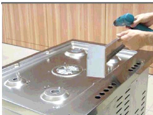
Si les orifices ne sont pas alignés, dévisser partiellement les supports à l'arrière du plan de travail comme indiqué ci-dessous.
