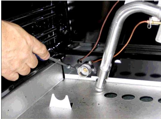
Régler le flux d'air principal en dévissant la vis P et en fixant l'intervalle X dans le cône de Venturi à 1/2" (5/16" pour le gaz naturel).
