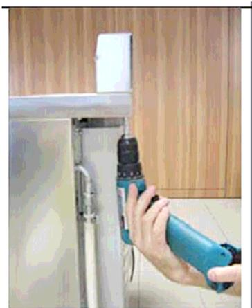
Positionner la partie arrière de la protection arrière et la fixer au plan de travail en serrant les 4 vis du fond.
