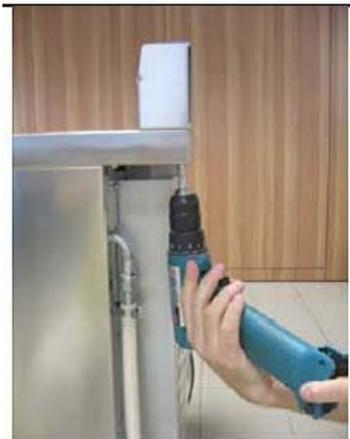
Positionner la partie arrière de la protection arrière et la fixer au plan de travail en serrant les 4 vis du fond.
