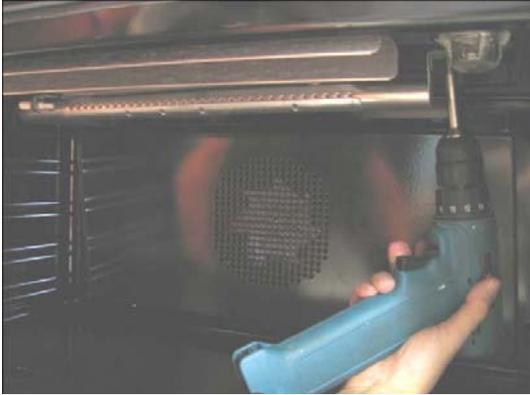
En utilisant un [nom de l'outil] de 7 mm., dévisser l'injecteur. Remplacer l'injecteur en utilisant l'équipement de conversion fourni avec la cuisinière ou par un magasin Bertazzoni agréé de pièces de rechange. Chaque injecteur comporte un numéro indiquant son diamètre de flux imprimé sur le corps. Consulter le tableau à la page 22 la correspondance entre les injecteurs et les brûleurs.
