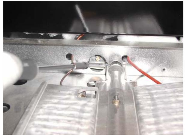
Dévisser l'injecteur situé dans l'adaptateur pour le gaz en utilisant une [clé à douille] de 7 mm.
