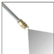
**Buse 40-degré :** Buse de lavage. Son jet d'eau étant plus large, la pression est répartie sur une plus grande surface. Elle est recommandée pour les travaux de rinçage et de lavage modéré. Son usage est idéal pour laver les recouvrements d'aluminium, les vitres, les véhicules et nettoyer les trottoirs, l'entrée de garage et les patios.
