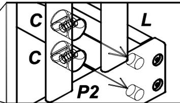
Écrou de boulon à insérer de l'intérieur
