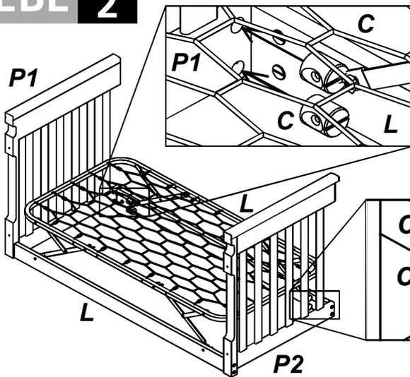
Écrou de boulon à insérer de l'intérieur
