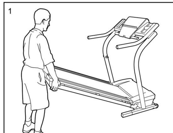
2. Mettez votre main droite dans la position illustrée et tenez le tapis roulant fermement. Avec votre main gauche, tirez le bouton de verrouillage à gauche et tenez-le. Soulevez le tapis roulant jusqu'à ce que le bouton de verrouillage est alignée avec le trou du verrou. Insérez le bouton de verrouillage dans le verrou. **Assurez-vous que le bouton de verrouillage est complètement inséré dans le verrou.**
