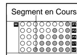
la colonne clignotante de la piste électronique. (Les points de repère de l'inclinaison ne sont pas affichés sur la piste électronique). Pour programmer la vitesse et l'inclinaison désirées pour le premier segment, ajustez tout simplement la vitesse et l'inclinaison du tapis roulant au niveau désiré avec les touches Vitesse et Inclinaison. Après plusieurs fois qu'une des touches Vitesse est pressée, un indicateur de plus s'allumera ou s'éteindra dans la colonne de Segment en Cours.
