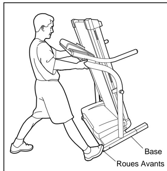
3. Placez un pied sur la base et pivotez doucement le tapis roulant jusque dans la position de rangement.
