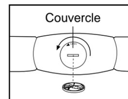
Ensuite, retirez la vieille pile de l'unité du détecteur. Insérez une nouvelle **pile CR2032**, en vous assurant que les lettres sont au-dessus. De plus, assurez-vous que la rondelle en caoutchouc est à sa place dans l'unité du détecteur. Refermez le couvercle de la pile et tournez-le dans la position fermée.
