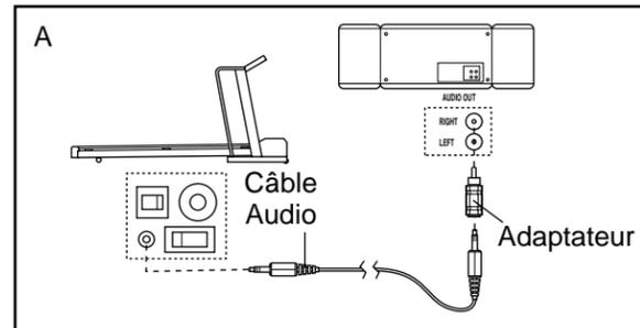
B. Branchez une extrémité du câble audio dans la prise qui est à l'avant du tapis roulant près du cordon d'alimentation. Branchez l'autre extrémité du câble dans la prise LINE OUT de votre stéréo.
