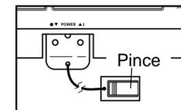
Ensuite, insérez la clé dans la console. Testez la pince en vous éloignant avec précaution de quelques pas en arrière jusqu'à ce que la clé sorte de la console. Si la clé ne sort pas de la console ajustez la pince. Ensuite retirez la clé de la console.
