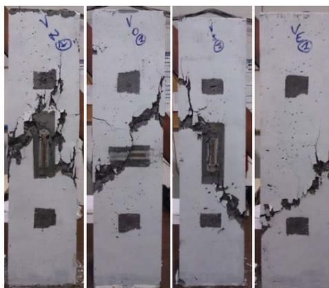
**Figure 5.14 - Rupture pseudo-fragile avec une seule macrofissure. Vues de
