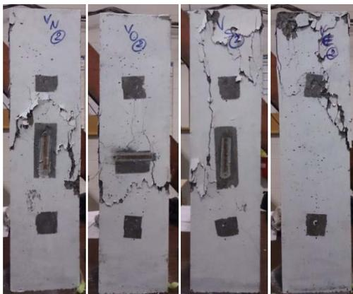
**Figure 5.15 - Rupture pseudo-fragile avec plusieurs macrofissures. Vues de CARV\_A150\_L600-2**
