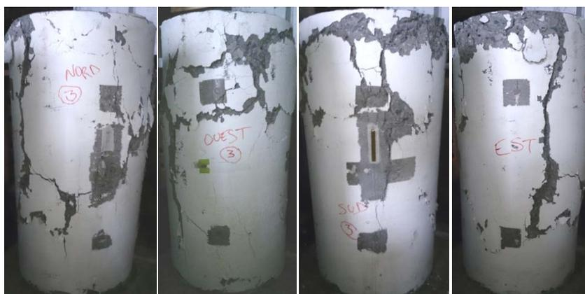
**Figure 5.17 - Rupture ductile avec plusieurs macrofissures : Vues de CYL\_D300\_L600-3**
