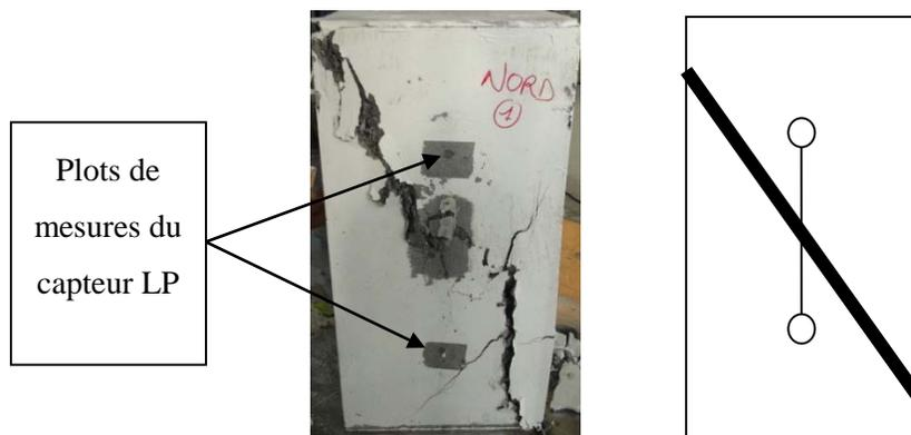
**Figure 5.18 - Prise en compte des données fournies par les capteurs LP en phase post-pic sur la face Nord du spécimen CARV\_A300\_L600-1**
