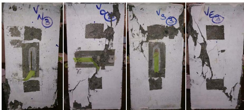
**Figure 5.16 - Rupture ductile avec une seule macrofissure. Vues de CARV\_A150\_L300-3**
