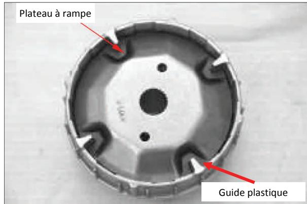
A ce stade, vous pouvez remplacer la demi-poulie fixe et remplacer les galets par des galets d'origine ou à cames.
