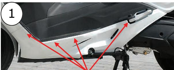
Dévisser les quatre vis et déposer le cache latéral gauche
