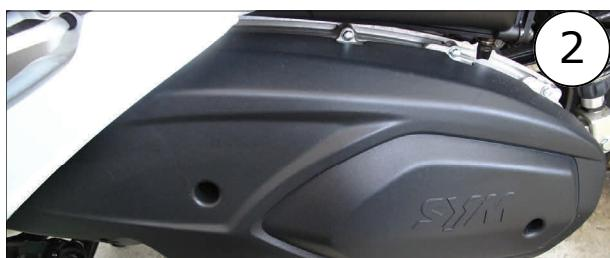
Dévisser les quatre vis et déposer le cache
