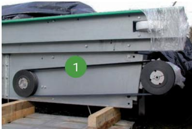
N°16 - L'entraînement de la vis chariot, les courroies (1), les poulies.
