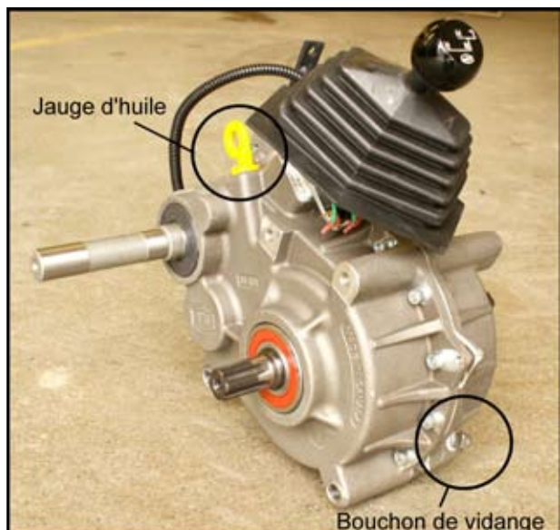
Figure 6-4a. Transmission 34-100 indiquant la position de la jauge d'huile et du bouchon de vidange.
