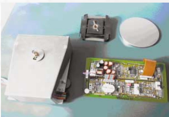
Capteur de pesage Sartorius WZ224-CW avec poids d'ajustage interne motorisé
