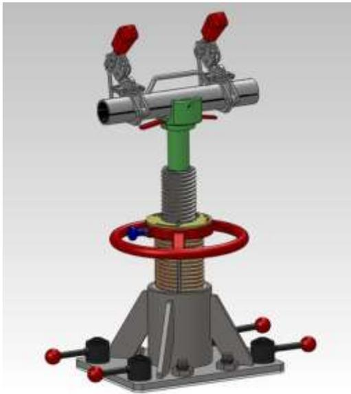
Tourner tous les 4 leviers de tendeurs rapides sur 90° jusqu'à ce qu'ils soient positionnés parallèlement au rail de montage. Voir Figure.
