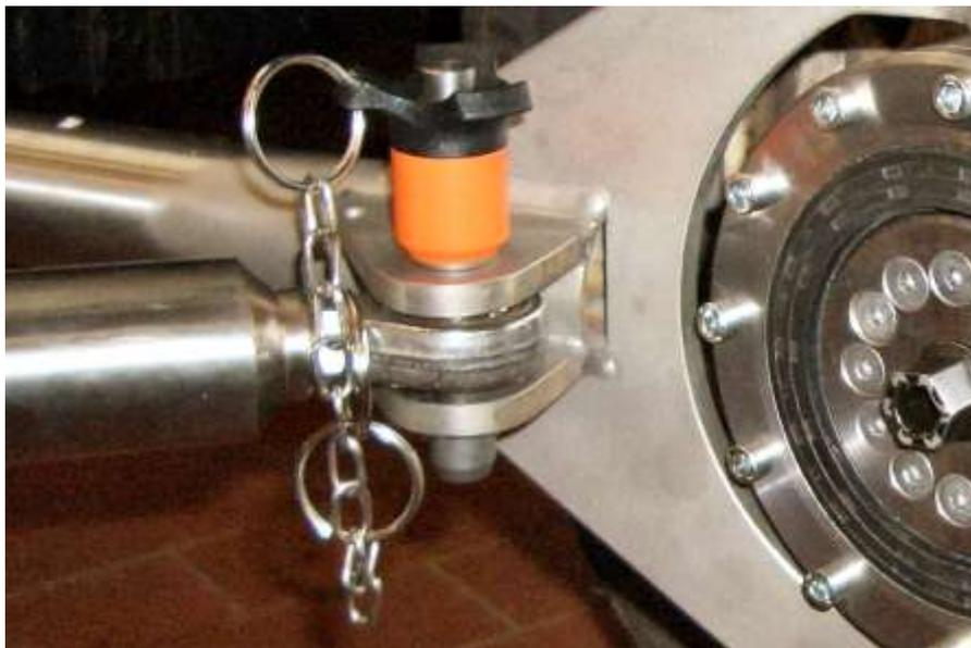
Figure 29 : axe de verrouillage à billes monté correctement
