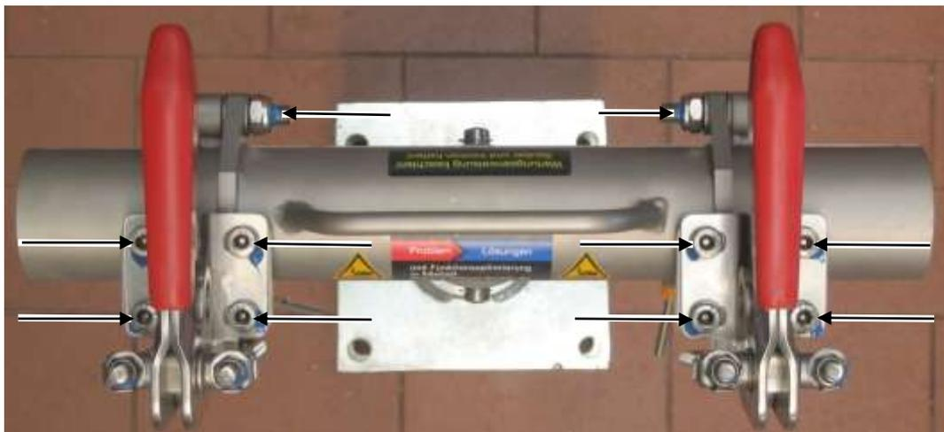
Figure 33 : peinture de marquage de vis sur le logement de barre.
