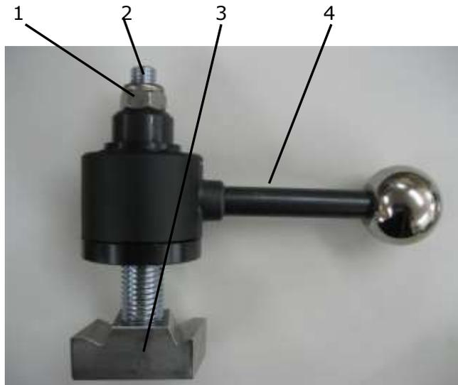
Figure 13 : tendeur rapide avec coulisseau
