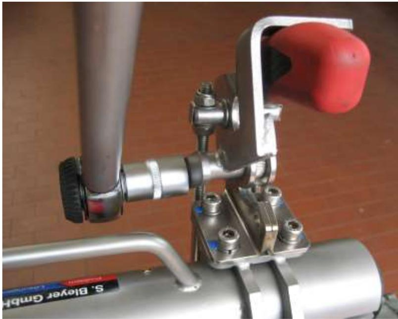
Figure 32 : outil pour le réglage de la force de serrage
