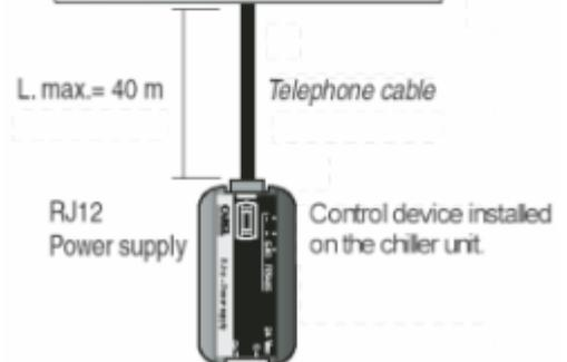
La connexion entre le terminal et l'unité s'effectue à l'aide d'un câble téléphone (longueur maxi : 40 mètres).
