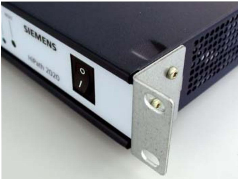
Figure 3-7 HiPath 2020 et HiPath 2030 – Equerre de support montée
