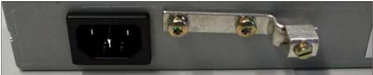
Figure 3-9 HiPath 2020 et HiPath 2030 – Prise de raccordement au secteur et barrette de conducteurs de protection
