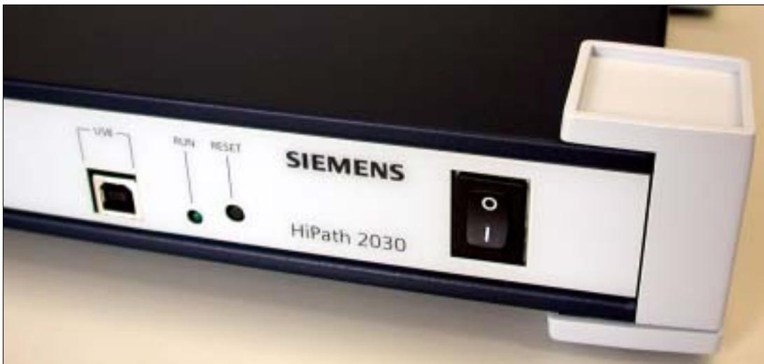
Figure 3-20 HiPath 2020 et HiPath 2030 (figure) – LED Run et commutateurs
