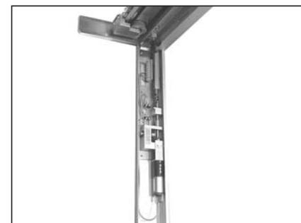
7. Insérer l'unité montée sous l'entraînement, aligner et serrer les quatre vis d'arrêt M6x16 Verbus-Ripp (12 Nm).
