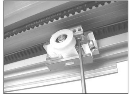
3. Dévisser trois vis à tête cylindrique M5x8 (1) sur le côté inférieur du chariot de roulement (couple de serrage au montage : 7 Nm).
