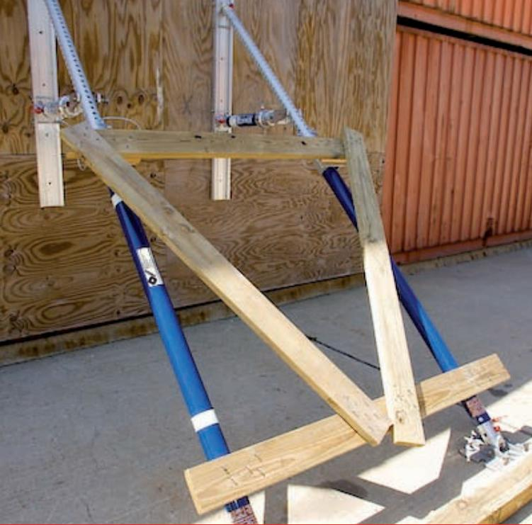
En outre, l'assemblage constitué par les étais, les poutrelles et les accessoires peut être complété pour former une sorte de «construction volante» et permettre ainsi aux forces d'intervention de réaliser un étaieement au dessus d'un amas de murs écroulés, de blocs de rochers ou d'éboullis.
