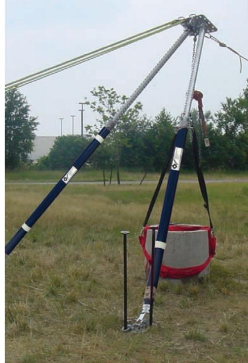
Si l'on doit procéder à un étaielement extrêmement important, il est nécessaire dans ce cas de recourir au dispositif prévu pour les charges lourdes. Composée de 3 étais, d'une platine supérieure et d'un socle, la colonne tripode pour charges lourdes offre une résistance à la pression de plus de 36 t.
