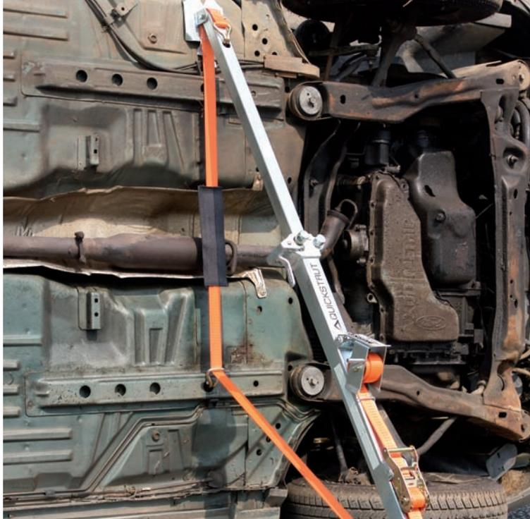
Le système d'étaie rapide a été spécialement conçu pour la stabilisation sûre et fiable du véhicule.
