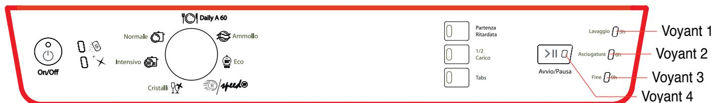
Sur les machines avec interface à leds, l'erreur sera visualisée sous forme binaire. Par exemple, l'erreur 05 est signalée par le clignotement des leds 1 et 3, l'erreur 11 par le clignotement simultané des leds 1, 2 et 4.
