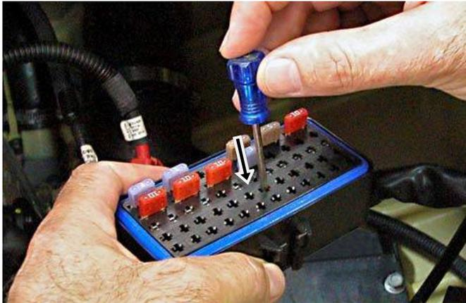
**TERMINAL retrait:** Insertion de l'Outil DANS Fourni fentes en haut et en bas de la charge Déprime verrouillage de onglets (voir ci-Dessous). Il may être de Nécessaire d'enlever les fusibles safe place d'insérer Complètement tool.
