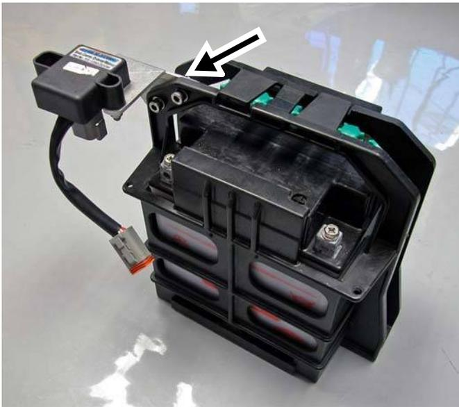
Secure SCOM soutien au soutien de batterie AVEC Fournis matériel (point Fourni # 2). NOTE: Ne Pas Trop Serrer les Boulons.
