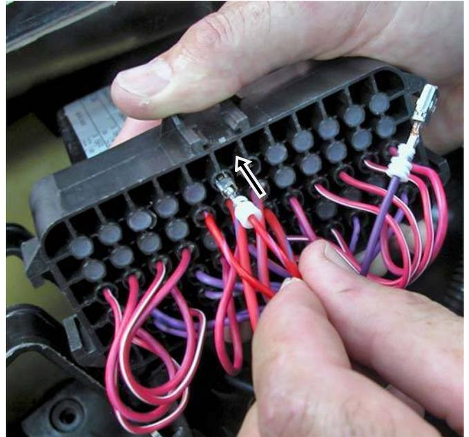
Insérez l'extrémité du fil Electrical Harness (fourni le point 4 - De petit calibre fil violet) dans l'emplacement "E6". (Ecoute un clic!) Tirez sur le fil pour s'assurer terminal est verrouillé en place.
