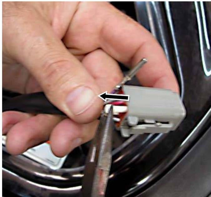
Insérez l'extrémité du Electrical Harness Wire (violet fil) DANS Connecteur et le verrouiller en place. (Ecoute clic de l'ONU!) Mettre à tirer Retour sur le fil verrouillé intérêt s'assurer terminal en place.
