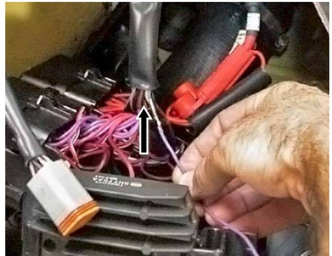
RSS fil violet et DANS A travers la première section de gainage de Connecteurs Régulateur de tension. Pull violet fil à Travers la section première de la gaine. Insérer aliments et verser Deuxième Partie en d'Une enveloppe Jusqu'à la fin Atteint Connecteur de diagnostic.
