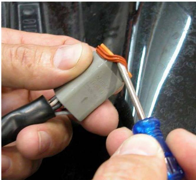
Soulevez soigneusement bord de la protection du Connecteur verser Retirer
