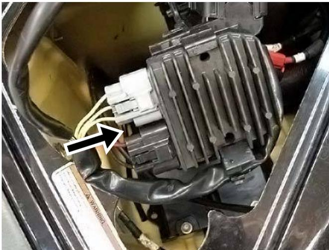
Tourner le Soutien Composants Electriques vers une Accéder fusible boîtes. Retirer la boîte la plus Proche fusible du Régulateur de tension de l'appui des Composants Électriques.
