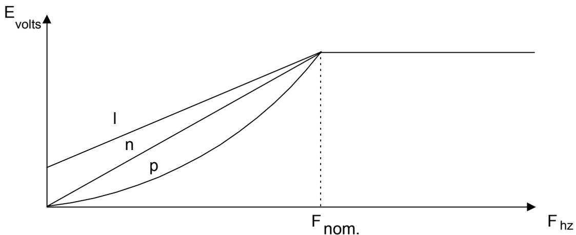
FIGURE 5.25 COURBE TENSION-FRÉQUENCE
