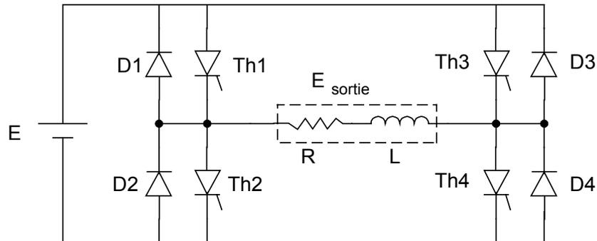
FIGURE 5.7 ONDULEUR MONOPHASÉ EN PONT
