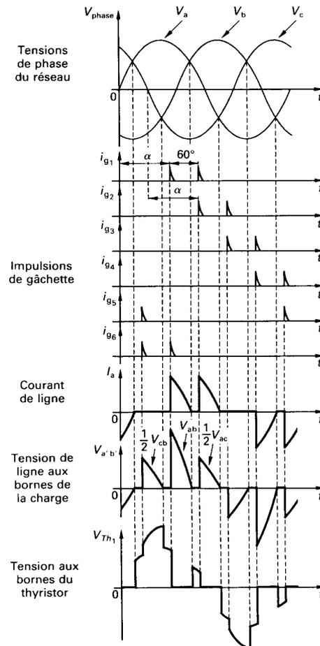
FIGURE 6.4 FORME D'ONDE POUR UN GRADATEUR TRIPHASÉ
