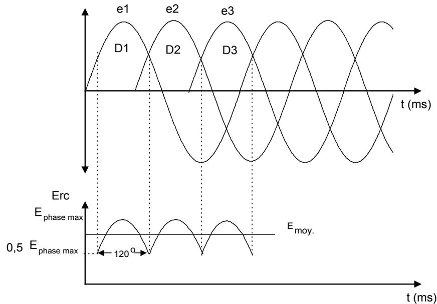
FIGURE 2.5 FORME D'ONDE D'UN REDRESSEUR TRIPHASÉ SIMPLE ALTERNANCE
