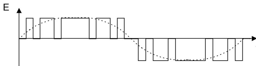
FIGURE 5.4 FORME D'ONDE À MODULATION DE LARGEUR D'IMPULSION
