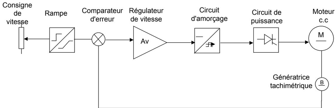
FIGURE 4-9 ASSERVISSEMENT DE VITESSE D'UN MOTEUR C.C
