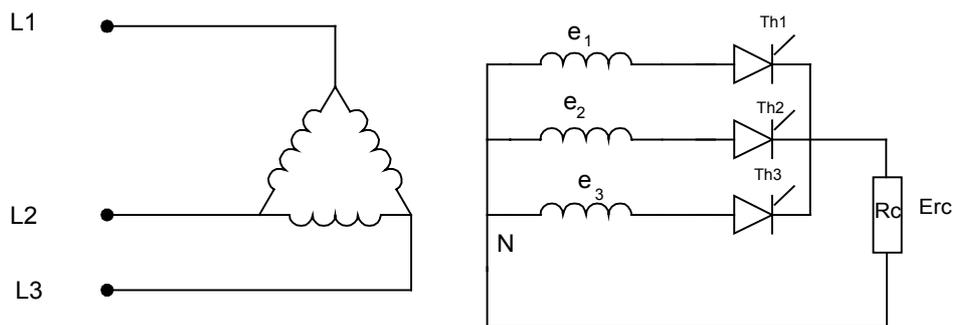
FIGURE 2.11 REDRESSEUR COMMANDÉ TRIPHASÉ À SIMPLE ALTERNANCE
