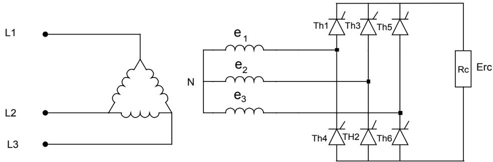
FIGURE 2.14 REDRESSEUR TRIPHASÉ EN PONT COMPLETEMENT COMMANDE
