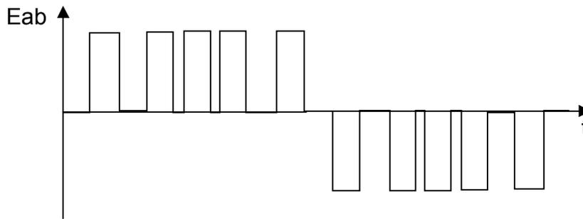
FIGURE 5.19 FORME D'ONDE DE SORTIE D'UN ONDULEUR MLI
