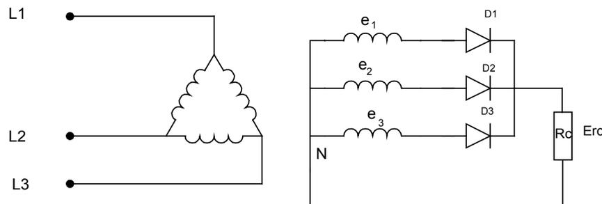
FIGURE 2.4 REDRESSEUR TRIPHASÉ SIMPLE ALTERNANCE
