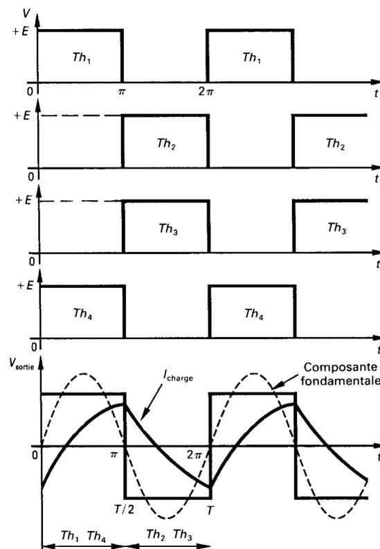
FIGURE 5.8 FORME D'ONDE POR UNE COMMANDE SYMÉTRIQUE
