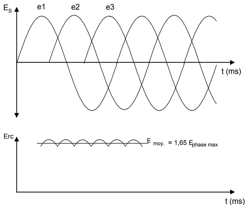
FIGURE 2.7 FORME D'ONDE D'UN REDRESSEUR TRIPHASÉ EN PONT
