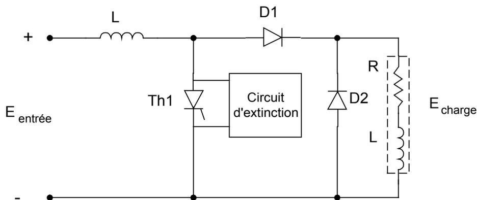
FIGURE 3.5 HACHEUR SURVOLTEUR
