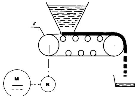
FIGURE 4-21 CONVOYEUR À AGRÉGATS
