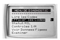
✓ Si les résultats et codes de diagnostic ne doivent pas être effacés, utilisez la touche flèche vers le bas pour signifier NON.
