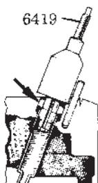
4. Extraire la douille en cuivre à l'aide de l'extracteur 6657. Si la rallonge de la douille, au fond de la culasse, se brise, employer l'extracteur 6372. Le joint torique dans la partie supérieure de la culasse est enlevé en même temps que la douille en cuivre.
