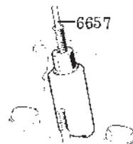
5. Nettoyer la surface d'étanchéité entre la culasse et la douille en cuivre. Mettre un nouveau joint torique dans la culasse.
