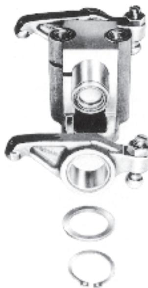
Fig. 39. Mécanisme de culbuteurs
