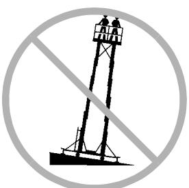
Ne pas lever la nacelle si la machine n'est pas à niveau. Ne pas installer la machine sur une surface où elle ne peut être mise à niveau avec les seuls stabilisateurs.
