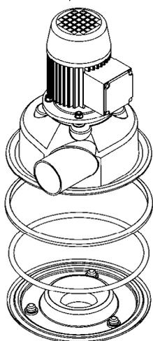
3. Positionner le joint torique et la partie supérieure de la volute sur la partie inférieure, fixer les deux moitiés de la volute avec l'anneau de serrage.
