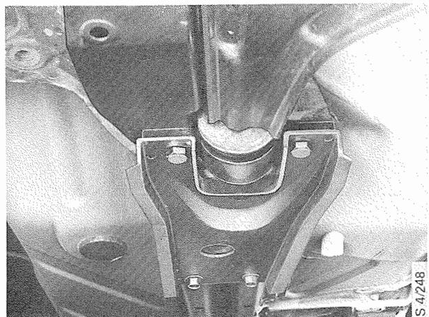
8. Monter le bras oscillant dans la rotule et le serrer à fond.
