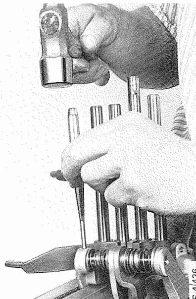
2. Expulser l'axe en frappant le levier. Démontez les circlips du levier et retirez les ressorts et les douilles.
