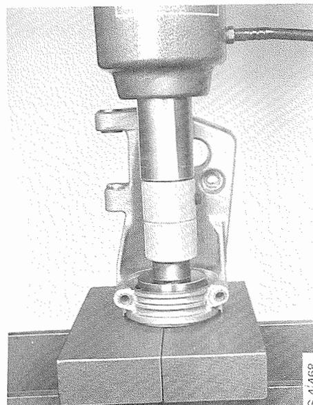
2. Monter le déflecteur de salissures et la bague torique sur l'entraîneur.
