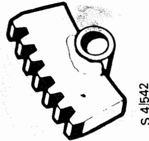
83 92 987 Blocage de volant moteur Démontage, montage d'embrayage
