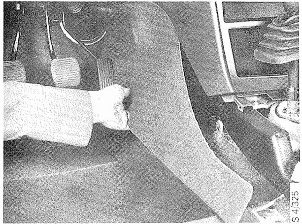
8. Démonter les vis et repousser en place le canal d'air arrière.
