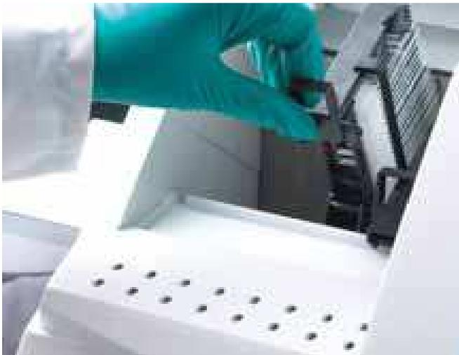
Lorsqu'un panier de lames est terminé, il vient se placer en position de sortie. Un flux d'air permet d'accélérer le séchage des lames. L'utilisateur peut venir retirer les paniers selon sa disponibilité. L'appareil émet une alarme à chaque fin de cycle et lorsque l'espace de déchargement est complet.
