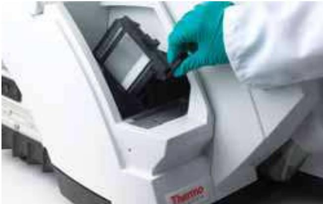
L'utilisateur positionne le panier de lames à coller dans l'espace de chargement. Les paniers peuvent être mis en place par série de 5 ou individuellement. Un réservoir de solvant peut être mis en place pour éviter le séchage des lames.
