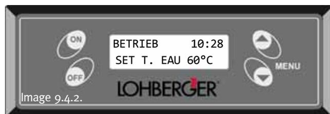
REGLAGE T. AMB. (peut être réglé entre L (bas) 10 et 40 °C, et H (haut) indique la température réglée sur la sonde (*Image 9.4.2.*). Dès que la température ambiante atteint la température réglée, le poêle se commute sur le niveau de puissance le plus bas (1); pour le réglage procéder comme suit :
