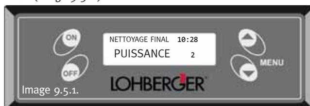
Le système d'alimentation de pellets s'arrête immédiatement, tandis que le ventilateur à fumées s'arrête automatiquement quand le poêle est froid.
