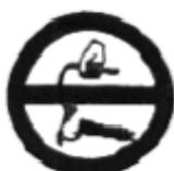
Das Gerät darf nicht am Luftschaub getragen werden, um Beschädigungen des Schlaubes oder des Luftanschlusses zu vermeiden, da dies zu Verletzungen während des Betriebes führen kann.
