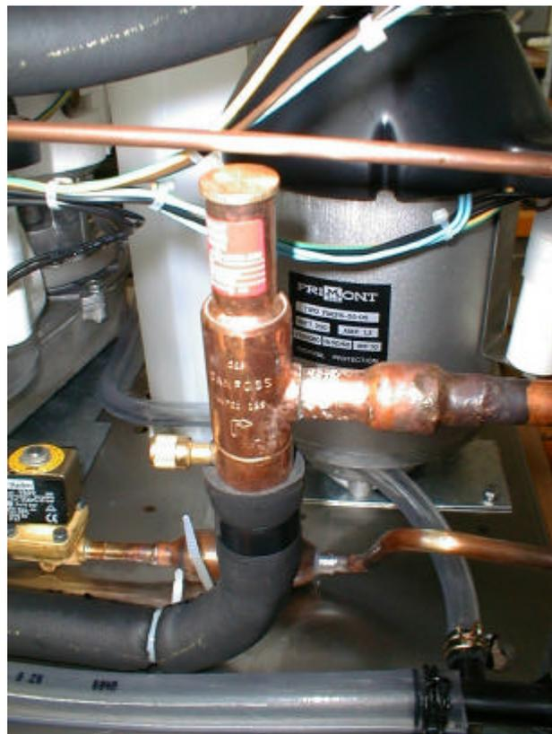
L'impianto refrigerante viene fornito completamente sigillato mediante due tappi di rame chiusi da bocchettoni, e precaricato con una quantità limitata di R404a.
