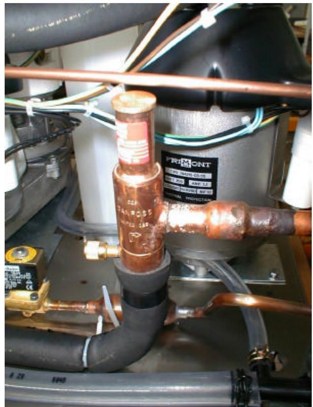
Le circuit frigorifique est hermétiquement fermé par deux capsules de cuivre vissées par les écrous des raccords flare et pré-chargé avec du gaz réfrigérant R 404 A.
