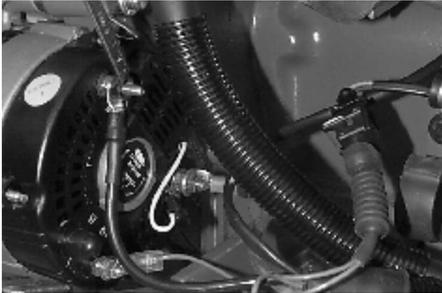
Retirez les bornes électriques de l'alternateur. Clés de 7, 8 et 10 mm.
