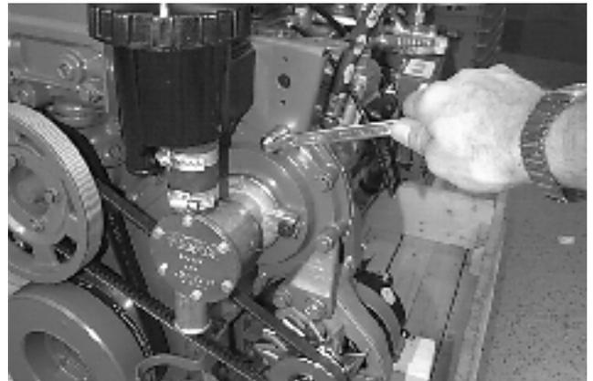
Posez la pompe à eau de mer, le filtre à eau avec le support et le flexible à la borne avant du refroidisseur d'air de suralimentation et à l'admission d'eau (bouclier).
