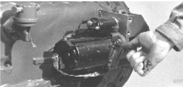
Déposez le démarreur. Clé de 15 mm.
