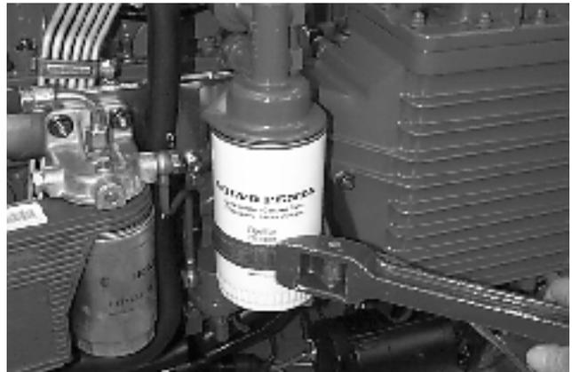
Retirez les connecteurs du capteur de pression d'huile et du contacteur de pression d'huile. Retirez le filtre à huile à l'aide de l'outil 999 9179 et de l'adaptateur. Clé de 12 mm (KA(M)D42/43/44/300).
