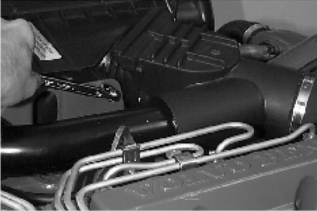
Installez le compresseur du conduit d'air – filtre à air. Utilisez des joints toriques neufs et plongez-les dans une solution savonneuse pour faciliter l'installation du conduit d'air. Installez le filtre à air. Clés de 10, 11 mm. Installez le conduit entre le turbocompresseur – le filtre à air – le compresseur. Les bornes du compresseur à l'entrée et la sortie sont rendues étanches par un produit d'étanchéité à la silicone, tel que Permatex® N° 6 ou Loctite® Silicon.
