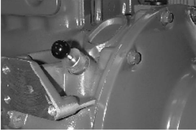
Posez l'outil 884 895 dans le carter du volant. Tournez le moteur dans son sens de rotation normale jusqu'à ce que l'oeillet de l'outil bloque le volant.
