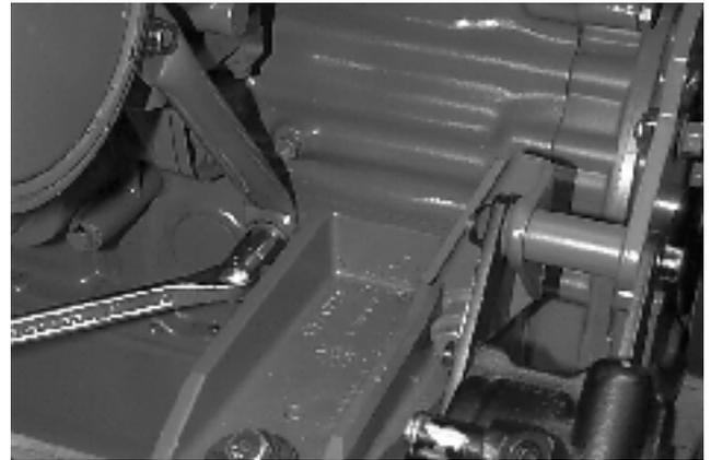
Retirez la vis inférieure de la bielle de l'échangeur thermique et du bloc cylindres. Clé de 17 mm.
