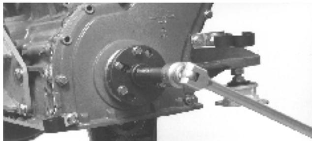
Revissez le boulon central sans le serrer, et sans la rondelle. Sortez le moyeu polygonal, utilisez l'extracteur 884 608 avec 3 vis de la poulie de courroie. Retirez la vis centrale.
