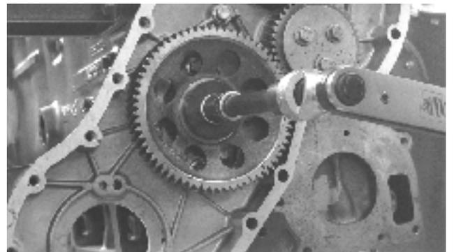
Posez la clé de l'arbre à cames. Contrôlez la position de l'arbre à cames de manière à ce que les repères correspondent à la poulie installée. Chauffez la poulie d'arbre à cames à environ 100°C et installez-la sur l'arbre. Couple de serrage **85 Nm**.
