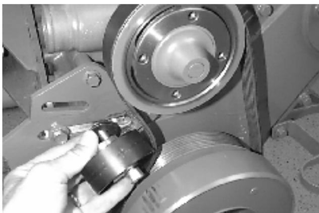
Posez la pompe de circulation et le support du tendeur de courroie. Clé de 12 mm, 13 mm.
