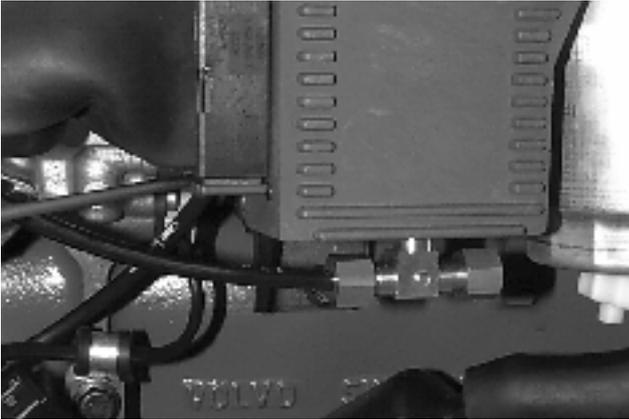
Retirez le connecteur de l'unité de commande diesel, abaissez soigneusement la goupille d'arrêt rouge en même temps que le connecteur est retiré (KA(M)D44/300).
