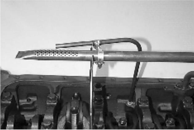
Retirez la conduite de refoulement d'huile et la conduite d'alimentation d'huile, ainsi que leur support. Douille de 12 mm.
