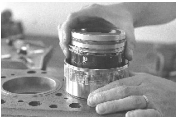
Posez les coussinets de tête de bielle. Lubrifiez les pistons, les segments de piston et les têtes de bielle. Tournez les segments de pistons pour que les écartements soient à environ 120° les uns des autres. Posez les pistons de sorte que les repères du devant pointent vers l'avant. Utilisez le segment d'installation 999 5031.
