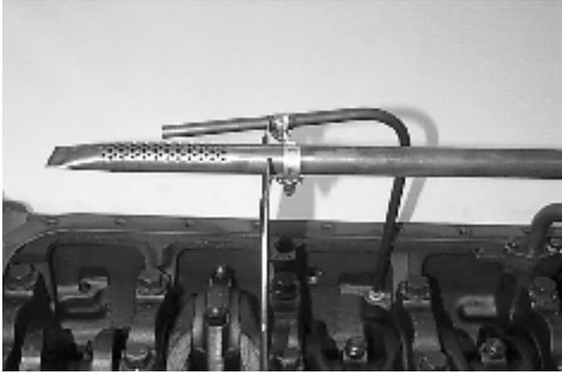
Monter la console (tôle à chicanes) sur le tuyau d'aspiration.
