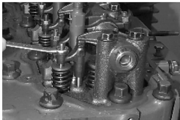
Desserrez le contre-écrou et la vis de réglage sur la paire de soupapes n°1 dans le cylindre 1 pour obtenir du jeu entre la fourche et la tige de soupape.
