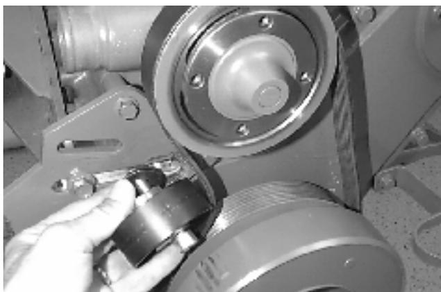
Desserrez et retirez la courroie d'entraînement de la pompe de circulation. Déposez la bobineuse de tension. Clé allen de 8 mm.
