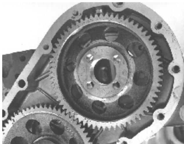
Retirez le carter de distribution avec une douille de 12 mm. Retirez le pignon d'injection de carburant.
