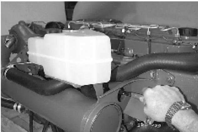
Posez le réservoir d'expansion, le support et les flexibles d'aération sur le turbocompresseur et le logement de thermostat.
