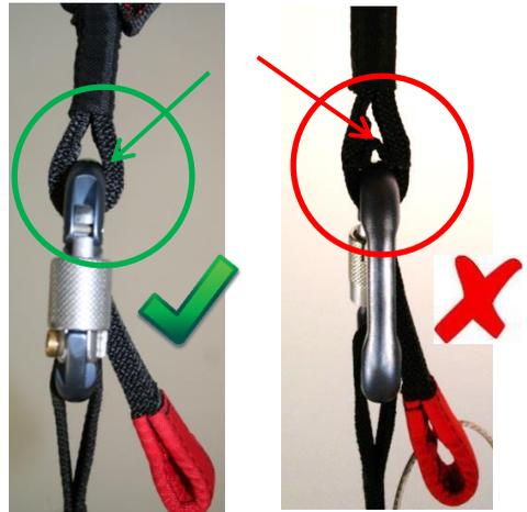
Fig. 7: Position du mousqueton pour le point d'accroche supérieur
