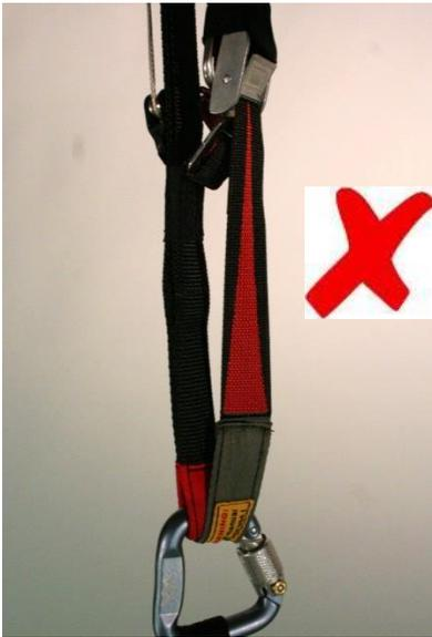
Bremsslider obere Position
