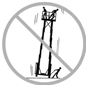
Ne pas lever la nacelle tant que le châssis n'est pas mis à niveau, que les quatre stabilisateurs ne sont pas correctement installés et que les vérins de mise à niveau ne reposent pas fermement sur le sol.
