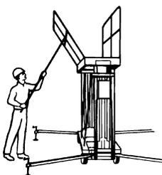
9 Tirer les goupilles de verrouillage de l'échelle et faire pivoter celle-ci vers le bas. S'assurer que l'échelle est verrouillée.
