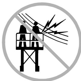
Se tenir à l'écart de la machine si elle touche des lignes sous tension ou si elle se charge électriquement. Le personnel au sol ou à bord de la nacelle ne doit pas toucher, ni utiliser la machine tant que les lignes électriques sont sous tension.
