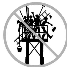
Le poids des occupants et du matériel ne doit en aucun cas dépasser la capacité maximum de la nacelle.
