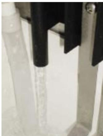
3. L'eau commence à remplir le réservoir d'eau jusqu'au le niveau maximal contrôlé par une sonde niveau d'eau.
