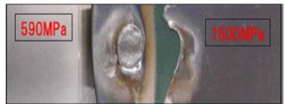
Résultats du test de traction de l'acier de 1 500 Mpa soudé
