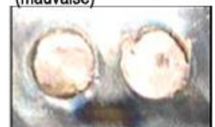
Sans soudure MIG pulsée (mauvaise)
