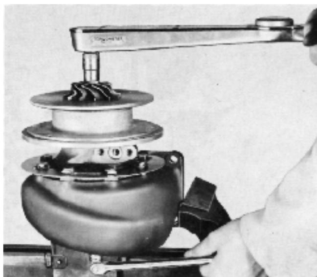
Fig. 111. Serrage des écrous de fixation pour la roue de compresseur
