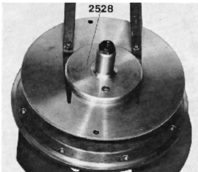
Fig. 109. Contrôle de l'écartement de la roue de compresseur
