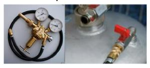
Réduction air de respiration 200 – 300bar à env 16 bar Tuyau de pression avec raccord d'air comprimé standardisé
