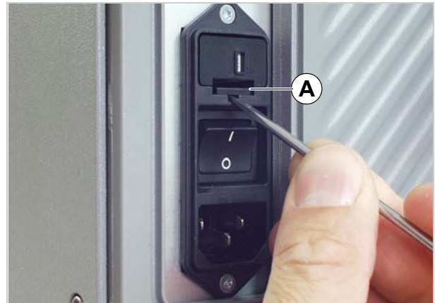
[52] Déverrouiller l'insert de fusibles.
