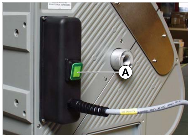
[48] Interrupteur principal (A) de l'ALS104 avec option de protection contre les projections.
