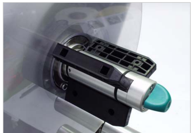
[43] Position de l'adaptateur à fond de filet pour un diamètre à fond de filet de 101,6 mm.
