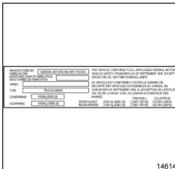
La plaque d'attestation de conformité est située à l'avant gauche inférieur du panneau de porte intérieur. Cette étiquette indique l'usine et la date de fabrication, le NIV, le type de véhicule, son poids et la pression de gonflage des pneus.
