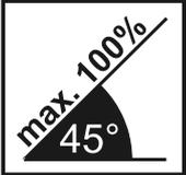
Ne pas utiliser la machine sur des talus ayant une pente supérieure à 45 degrés.
