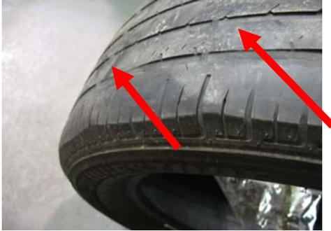
*Est-ce que les pneus arrière (ou les pneus avant permutés depuis l'arrière) du véhicule présentent des signes d'usure en diagonale ou d'usure des rebords intérieurs?*
