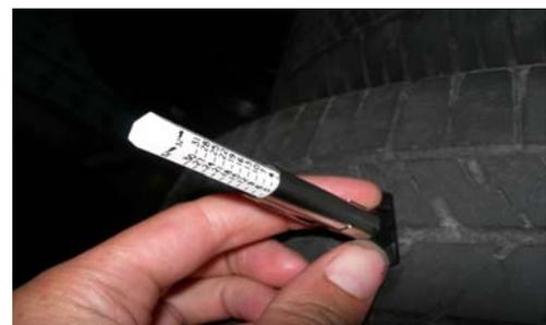
**Photo 3 :** Sélectionnez le pneu qui est le plus usé, et prenez une photo de la bande de roulement de façon à montrer les barres d'usure.
