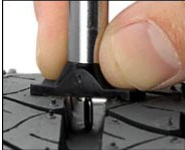
Dans certains cas, le rebord intérieur du pneu peut être usé au point de présenter des points sans rainures ou d'en être entièrement dépourvu. À ce moment, il se peut que la mesure de la profondeur de la rainure ne reflète pas bien le fait que le pneu a atteint la fin de sa vie utile. Dans un tel cas :
