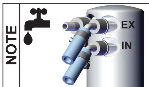
Contrôlez les raccords avant la mise en service. Fixez des raccords de tuyau de réfrigérant de manière à ne pas pouvoir se détacher de manière accidentelle (p.ex. avec des colliers de serrage).
