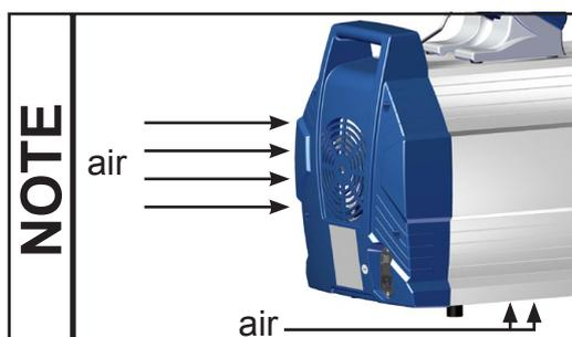
Veillez à une amenée d'air adéquate aux ventilateurs. Ne pas mettre la pompe sur une surface molle (p.ex. produits alvéolaires), ça peut bloquer ou gêner l'amenée d'air aux ventilateurs! Contrôlez régulièrement les grilles de ventilateur et nettoyez des grilles encrassées évitant une restriction d'amenée d'air.
