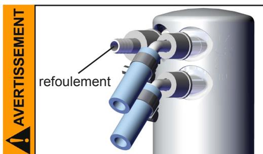
☞ Veillez à ce que la sortie de gaz (embout à 10 mm) ne soit pas bloquée. La conduite de sortie doit toujours être libre (sans pression) afin d'assurer que les gaz puissent sortir sans être gênés.
