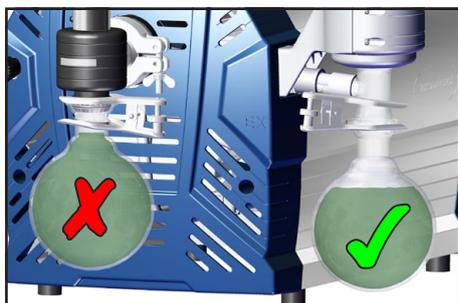
En cas de **formation de condensat**: Contrôlez régulièrement le niveau de condensat dans des ballons collecteur et vidangez-les à temps. Evitez un débordement des ballons collecteur. Si nécessaire, installez un capteur de niveau de remplissage (cf «Accessoires», seulement utilisable avec un régulateur CVC 3000 ou VNC 2 VARIO de VACUUBRAND).
