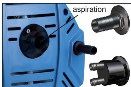
Le cas échéant, utilisez l'adaptateur aux deux raccords de tuyau ci-joint pour connecter jusqu'à deux tubes en PTFE 10/8 mm à l'aspiration, ou utilisez un adaptateur à embout DN 15 (pour tuyau à vide (caoutchouc), cf «Accessoires»).
