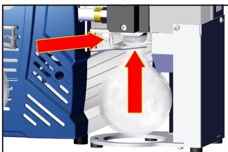
Le ballon collecteur est recouvert d'une couche protectrice à l'extérieur (protection contre débris de verre en cas d'implosion ou de dommage).
