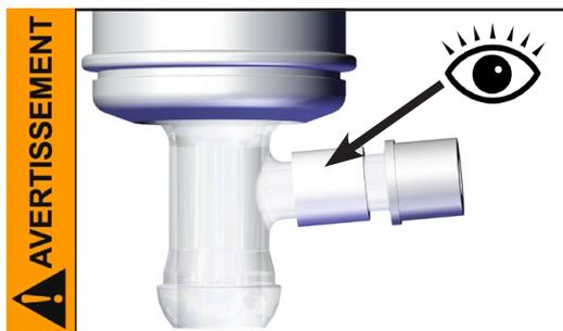
☞ Révisez régulièrement la **soupape de surpression** au condenseur de vapeurs. Remplacez-la si nécessaire. En particulier faites attention à la fragilité (fissures) ou à l'adhérence possible.
