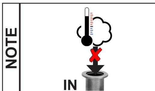
Évitez un apport de chaleur importante (par exemple à cause des gaz de processus chauds). Températures maximales admissibles: cf «Températures des gaz aspirés»
