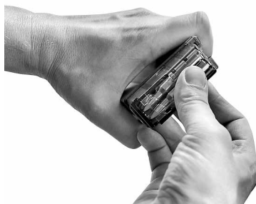
Illustration 24 Charger le chargeur
