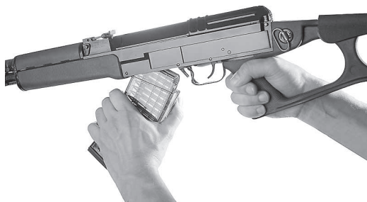
Illustration 27 Retirer le chargeur
