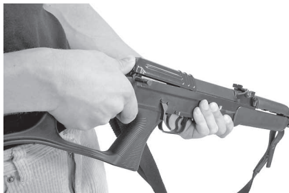
Illustration 28 Enlever le mécanisme de retour
