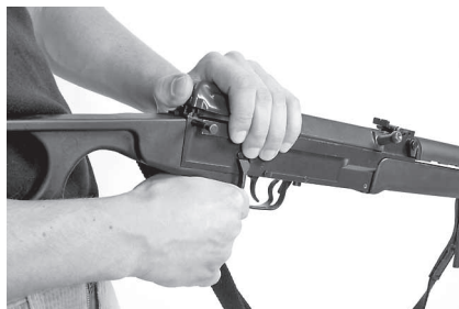
Illustration 28 Enlever le mécanisme de retour
