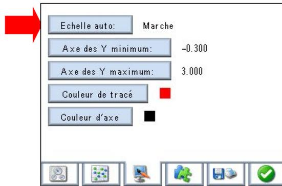
Si la fonction **Auto-Scale** est réglée sur **Off**, **Y-Axis Minimum** (minimum de l'axe des Y) permet de régler manuellement le plus bas niveau d'affichage de l'axe des Y. Appuyer sur la touche **Y-Axis Minimum** pour faire apparaître un clavier numérique pour la saisie de cette valeur. Cette valeur peut être choisie entre -0,300 et 2,999.
