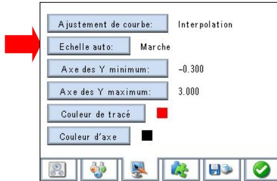
Si la fonction **Auto-Scale** est réglée sur **Off**, **Y-Axis Minimum** (minimum de l'axe des Y) permet de régler manuellement le plus bas niveau d'affichage de l'axe des Y. Appuyer sur la touche **Y-Axis Minimum** pour faire apparaître un clavier numérique pour la saisie de cette valeur. Cette valeur peut être choisie entre -0,300 et 2,999.
