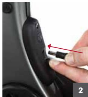
Tout en maintenant le capuchon de caoutchouc de la prise de charge ouvert, introduisez le câble de charge.
