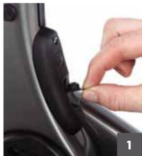
Ouvrez le capuchon de caoutchouc de la prise de charge.
