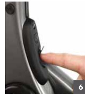
Lorsque la batterie est chargée à fond, enlevez le câble de charge et remplacez le capuchon de caoutchouc de la prise de charge.
