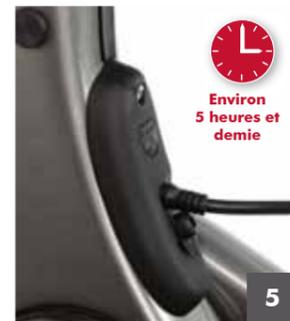
La charge est terminée lorsque le voyant du chargeur passe au vert et les dix voyants du tableau de bord clignotent (cf. 2<sup>ème</sup> étape / C)
