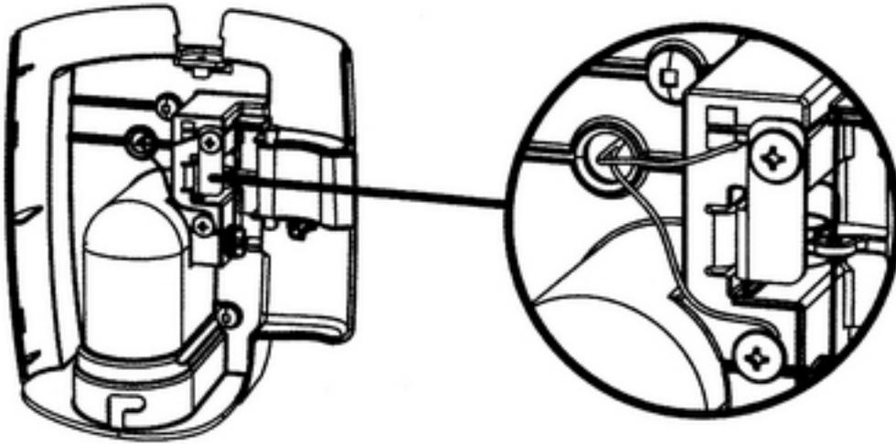
8. Refermer le panneau avant de la console, en s'assurant que les onglets de la porte et de la console soient alignés et qu'ils s'emboîtent parfaitement. Refixer la vis # 2.
